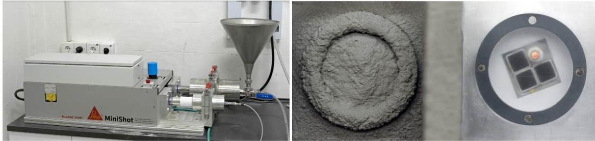
*Bild 1: Das MiniShot-Laborsystem zur realistischen Prüfung des Abbindens und Erhärtens von Spritzbeton anhand einer äquivalenten Zementpaste. Links das Applikationsgerät MiniShot, rechts eine gespritzte Probe und eine leere Messzelle des Ultraschall-Spektrometers Pulsment.*
